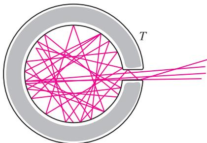
*Сосуд с излучением («черное тело»). Волны или лучи света много раз отражаются от стенок, при этом они поглощаются стенками и излучаются вновь; в результате устанавливается тепловое равновесие между излучением и стенками. Свет, выходящий из маленького отверстия в таком сосуде, будет иметь спектр «черного тела»*
