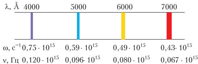
Схема спектра видимого света. Слева фиолетовый конец спектра, справа красный. Наверху длины волн в ангстремах, внизу частоты в обратных секундах. Количества энергии, падающие на выделенные четыре полоски спектра, относятся, как значения спектральной функции —  $f(0,120 \cdot 10^{15}) : f(0,096 \cdot 10^{15}) : f(0,080 \cdot 10^{15}) : f(0,067 \cdot 10^{15})$
