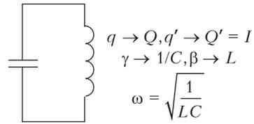
катушке и энергии электрического поля в конденсаторе. Энергия электрического поля конденсатора пропорциональна квадрату заряда  $Q$ , который в данный момент находится на обкладке конденсатора:
