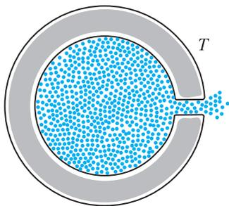
*Сосуд с газом. Атомы сталкиваются со стенками, и в результате устанавливается тепловое равновесие между газом и сосудом – газ приобретает температуру стенок. Число атомов при столкновениях не меняется. Чтобы измерить температуру газа, можно выпустить небольшую его порцию через маленькое отверстие*
